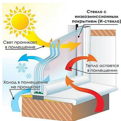
Рис. 4. Применение стеклопакета с тройным остеклением в пассивном доме
