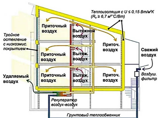
Рис. 7. Амплитуда движения воздуха в пассивном доме
