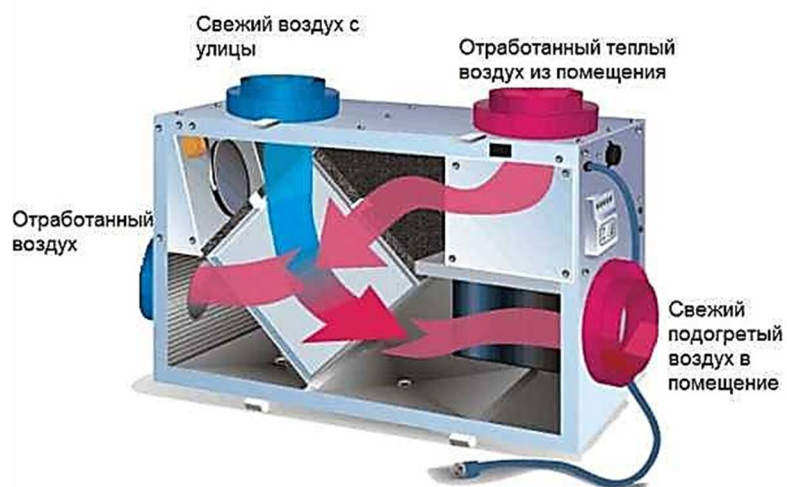
Рис. 6. Устройство рекуператора
